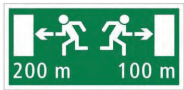
4.94 Richtung und Entfernung zum nächsten Notausgang
